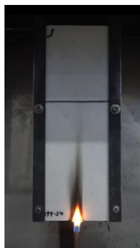
Fotografia 4 – A chama não atinge a marca de 150 mm.
