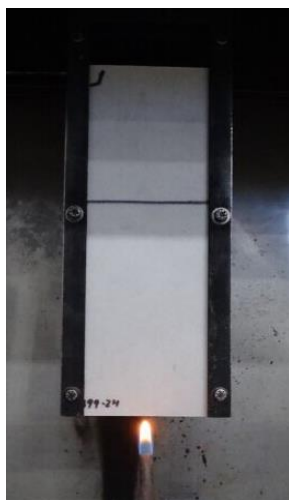
Fotografia 3 – Ensaio com o queimador aplicado na borda do corpo de prova.
