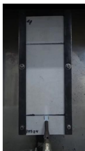
Fotografia 6 – A chama não atinge a marca de 150 mm.
